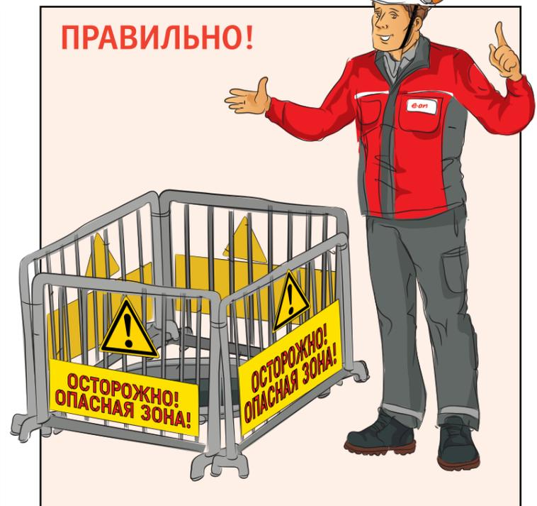
Опасные зоны (проемы в перекрытиях, стационарных площадках и стенах, каналы, приямки, котлованы, незакрытые люки колодцев и тепловых камер) должны быть ограждены по всему периметру. Элементы временных ограждений необходимо надежно закреплять. Ограждения должны быть прочными и устойчивыми при динамическом воздействии массы человека, хорошо видимыми в любое время суток. На ограждениях
