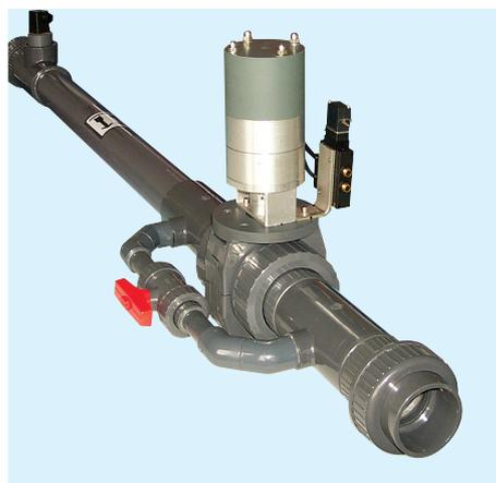
Для предохранения складских резервуаров при перекачивании из емкости поставки с использованием сжатого воздуха, Teschar предлагает быстродействующий предохранительный заправочный клапан как комплектный блок (быстродействующий клапан вкл. управление, зонд и байпасный клапан с трубопроводами) с условными проходами DN 32, 40, 50, 65 и 80. Могут выбираться следующие материалы: PVC, PP, VA (1.4571) и St.37.
