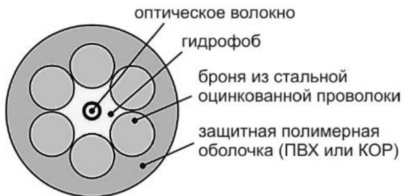
Рисунок 5.2.9 – Структура оптоволоконного кабеля чувствительного элемента
