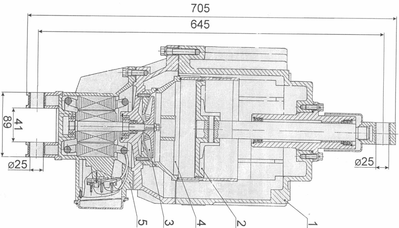
1-корпус, 2-поршень, 3-крыльчатка, 4-направляющий аппарат, 5-асинхронный электродвигатель, 6-пробка
